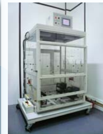
LW-9022P 室溫：+3~70°C 腔室尺寸：86x86x116 cm 門尺寸：90x90&30x60 cm 可程式溫度控制
