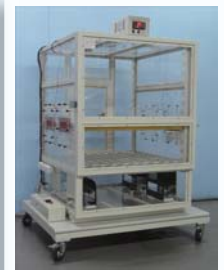
LW-9022G 室溫：+3~70°C 腔室尺寸：86x86x116 cm 門尺寸：90x90&37x76 cm 格柵式平台結構
